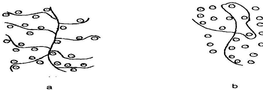
Gambar 7. Approach-ability kontaminan pada flokulan polimer: a. kopolimer cangkok, b. polimer linier. (Singh et al., 2000)
