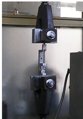
Gambar 5 Alat uji dipasang pada Autograph. (Lab. Kimia Murni F. MIPA ITB, 2005).
