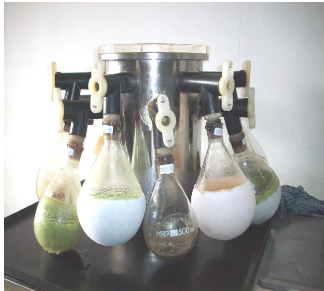
Gambar 4.12 Labu yang digunakan pada alat freeze drier
