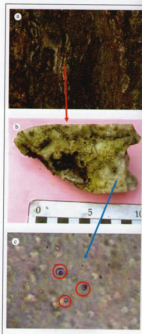
Gambar 13. Foto singkapan urat (a) dan percontoh untuk di analisis (b) pada elevasi 500 m dpt.; (c) Foto mikro inklusi fluida.
