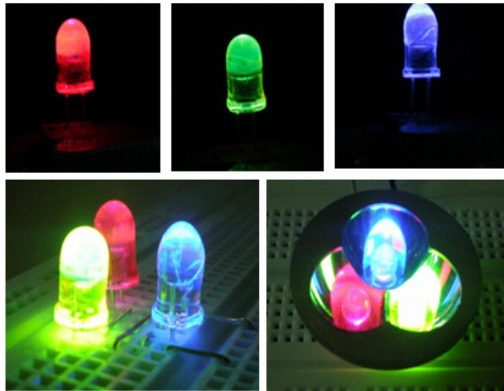
Gambar 9. Contoh emisi dari prototipe LED hibrid yang menggunakan bahan phosphor organik yang terdiri dari kromofor fluoresensi tunggal.
