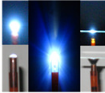
Gambar 8. Model prototipe LED hibrid dengan phosphor organik yang terbuat dari blend kromofor RGB organik dalam matriks polimer hibrid.
