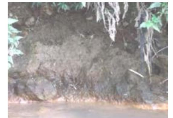
Gambar 6. Tanah lanau plastisitas tinggi (MH), Sungai Ciparungpang, Losari, Kab.Garut.
