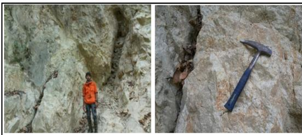
Gambar 13 . . Foto kenampakan singkapan tuf pada bagian baratdaya daerah penelitian pada stasiun JT15
