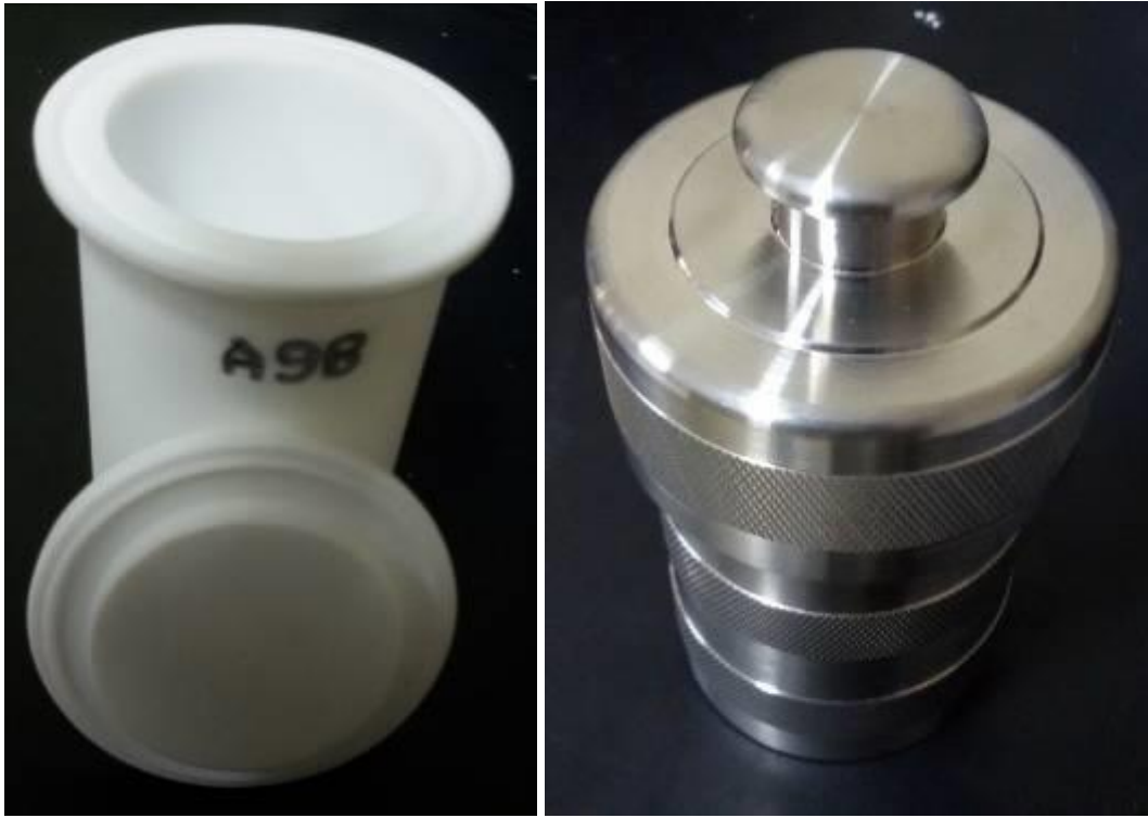
Gambar 7. Reaktor bagian dalam atau ruang sumur tempat reaksi (kiri) dan Reaktor lengkap sesudah semua komponen dipasang
