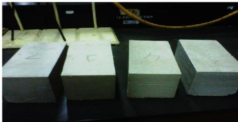
Gambar 3. Bata beton ringan
