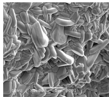
Gambar. 3 BBT hasil sintesis reaksi kimia padat dengan pembesaran 5000 kali
